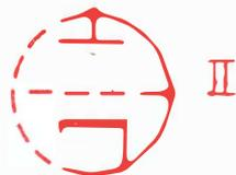
**TUBO A GAS.** La presenza del puntino nero nel simbolo di una valvola indica che la valvola è del tipo a gas e non a vuoto. L'altro simbolo con il tratteggio indica la stessa cosa, ma è usato più raramente.
